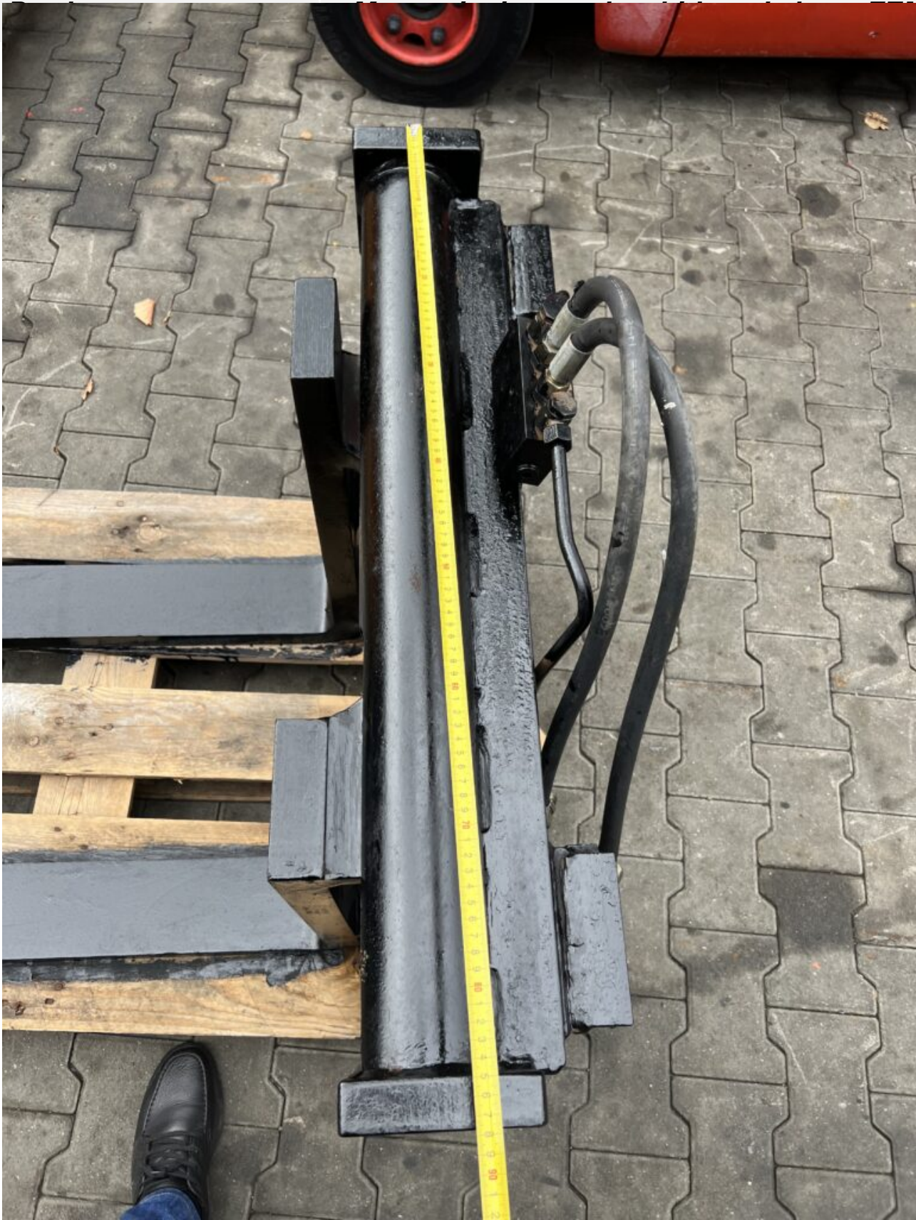
Masa stivuiitor cu deschidere de lame FEM II (41cm)
