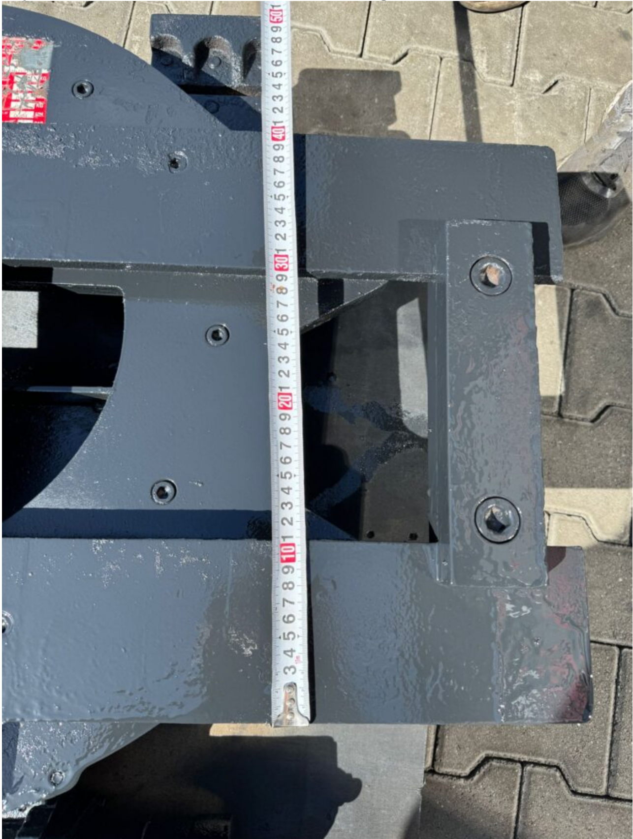
Dispozitiv rotativ 360° stivuiitor Fem II 41 cm, An 2019 Lungime masa 98 cm Pret: 2.650€ fara TVA
